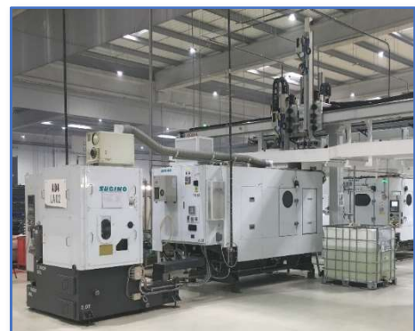
Installations de lavage permettant de respecter les exigences de propreté accrues, notamment par les normes anti-pollution.
