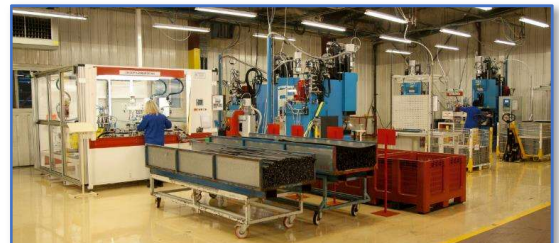
Cellules de finition (découpe, assemblage clips, flocage et revêtement)
