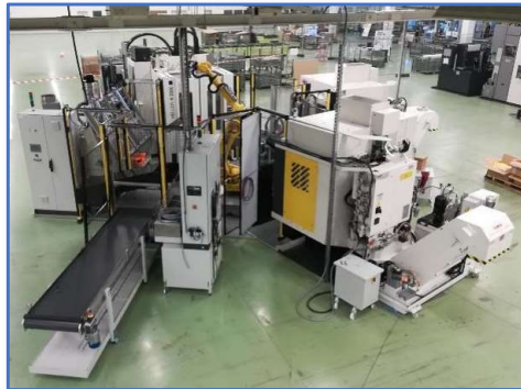
Cellules robotisées et lignes transfert d'usinage automatique supervisées par pilotage inertiel.
