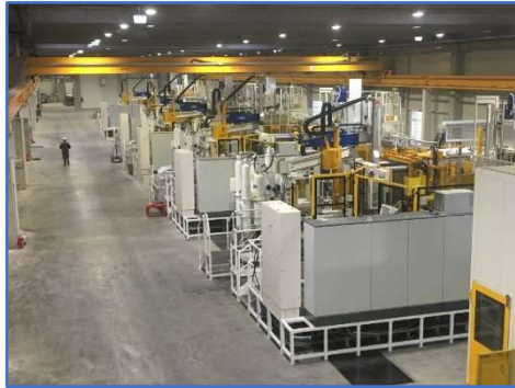
Presses à injecter jusqu'à 3000 T équipées d'une surveillance continue des paramètres de production.
