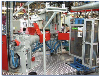
Lignes d'extrusion EPDM ou TPE sur les sites Français, Marocain et Roumain
