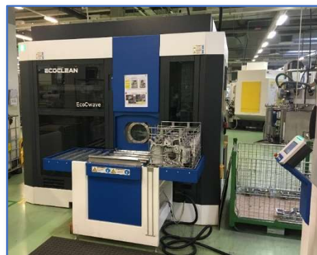
Installations de lavage permettant de respecter les exigences de propreté accrues, notamment par les normes anti-pollution.
