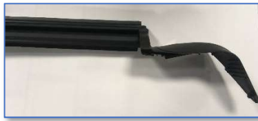
Lêcheur intérieur (Extrusion EPDM / Moulage TPV (EPDM+PP))
