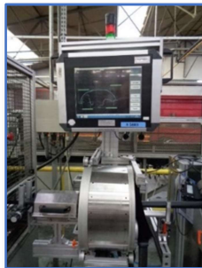
Contrôle dimensionnel / aspect en continu et mise à longueur automatique en flux avec ligne d'extrusion
