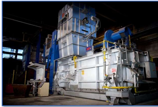
Four de fusion de l'aluminium – Capacité annuelle de production Eurocast voisine de 120 000 Tonnes.
