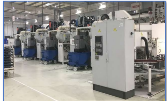
Cellules robotisées et lignes transfert d'usinage automatique supervisées par pilotage inertiel.
