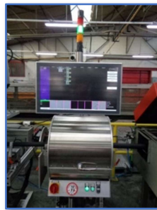
Contrôle dimensionnel / aspect en continu et mise à longueur automatique en flux avec ligne d'extrusion
