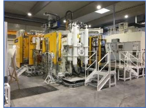
Presses à injecter jusqu'à 3000 T équipées d'une surveillance continue des paramètres de production.
